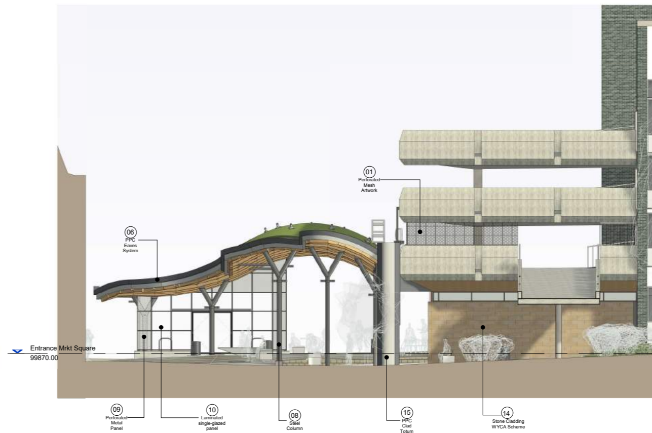
E3 North Elevation Scale: 1 : 100
