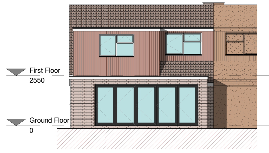
E3 Existing Rear Elevation 1 : 100
