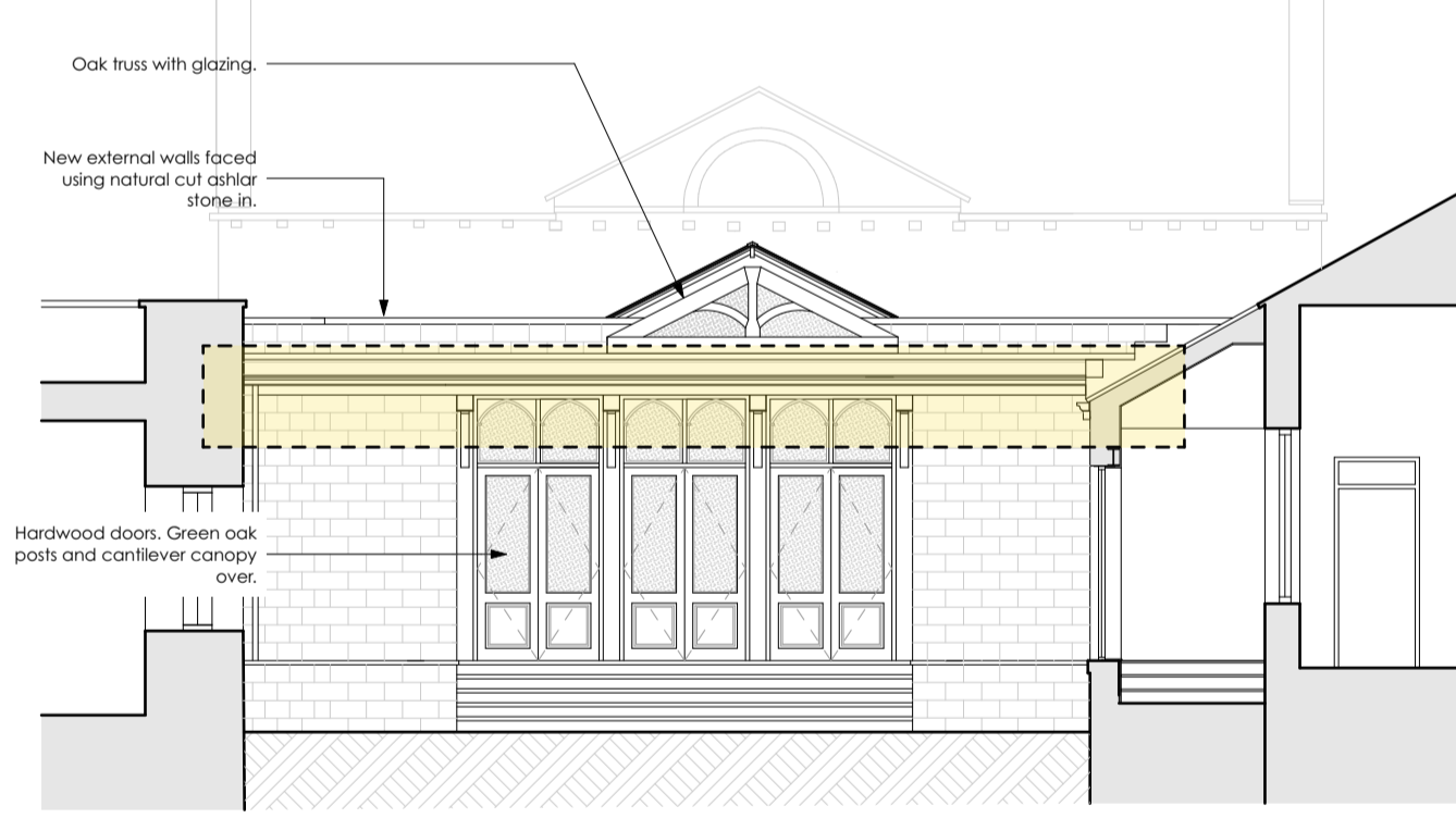
Sectional Elevation F1
